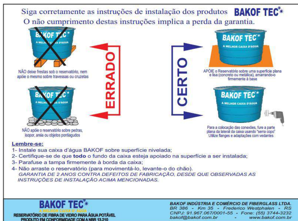
Figura 02: Etiqueta com Instruções de Instalação dos reservatórios Bakof Tec.
